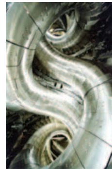
◆大型ヘリカル装置内部の真空容器30立方メートルの温度1億度のプラズマを閉じ込める。
