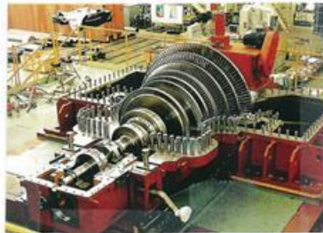
・蒸気タービン
