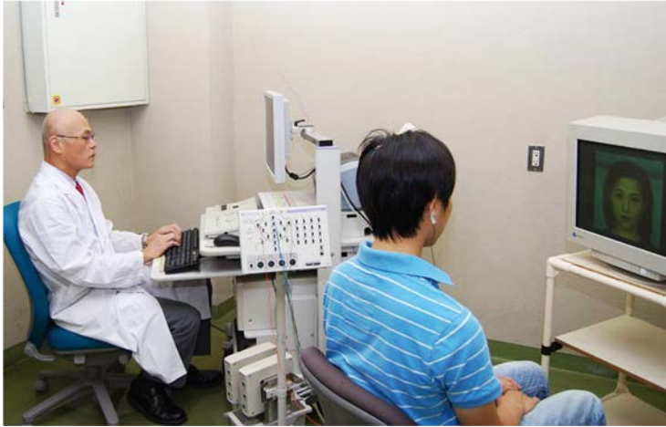
図1. 脳波を使ったうそ発見器の実験風景。被験者は脳波電極を付けてモニター上の画面を見ており、検査者は脳波だけを見て判断する。
