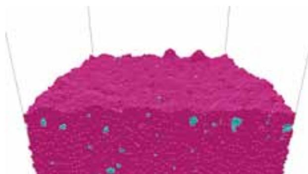
図 3 プラズマと接することで炉材料の表面が荒れていく様子をコンピュータで再現した様子。電子顕微鏡でも見ることでできない原子一つ一つの動きも、この様にコンピュータでシミュレーション可能です。炉材料であるタングステン (紫) にプラズマ状態のヘリウム (青) が侵入することで、固体の中にナノスケールの気泡ができるという不思議な現象が起こります。
