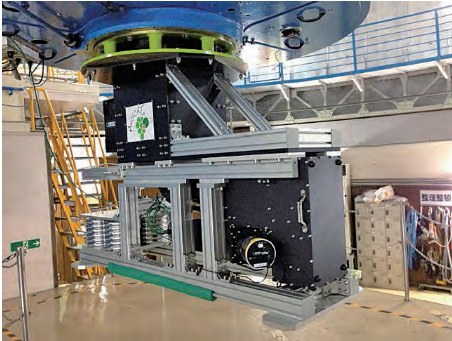
図1 岡山天体物理観測所188cm望遠鏡用に開発した3色同時撮像カメラMuSCAT
