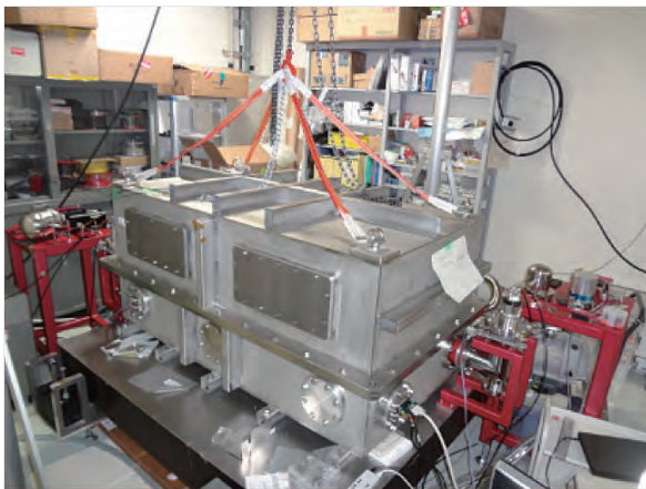
図2 すばる望遠鏡用に開発中の赤外線視線速度測定装置IRD
