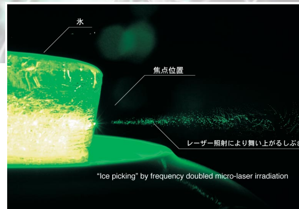
図1 マイクロレーザーの第二高調波（波長532nm）を氷に照射すると、ショット毎に水しぶきが上がる。消費電力16mW/pulseでも尖頭値で1.7MW、輝度温度で 2 \times 10^{20} Kの高輝度光が実現される
