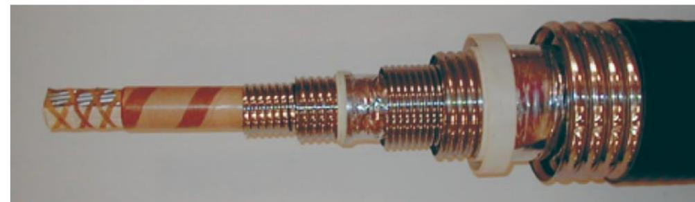
図2 大型ヘリカル装置（LHD）の直流電源と超伝導コイル群を結ぶ「超伝導バスライン」。外径22cm、総延長約500m。電流容量は、プラス側とマイナス側の導体を合わせると6万アンペア。本格的な超伝導送電ケーブルとして世界に先駆けて開発された。先進的な高温超伝導導体を用いることで電流容量を250倍に、ただし外径は3倍程度に抑えられる、長さを8万倍すれば、人工地磁気を発生する「超伝導グローバル・プロテクター」が建設できるかも？
