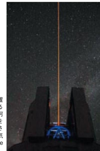
**図2** すばる望遠鏡用に開発したレーザーガイド星生成装置の試験風景。補償光学を使うには大気のゆらぎを測るための明るいガイド星が必要である。観測したい銀河のそばに明るい星が無い場合でも、レーザービームを撃って高度90 kmの大気中のナトリウム原子を発光させて人工レーザー星をつくり、その光を測定して空気のゆらぎを補償することができる (<http://subaru Telescope.org/Pressrelease/2006/11/20/fig2l.jpg>)
