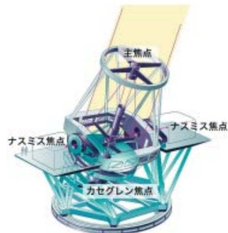
図1 すばる望遠鏡本体の概念図（遠藤孝悦・画）と焦点位置
