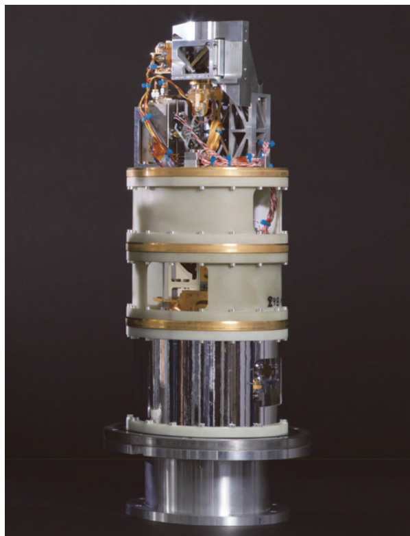
アルマ望遠鏡バンド10受信機 Credit: 国立天文台
