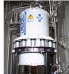
生体分子の精密構造解析用 920MHzNMR
