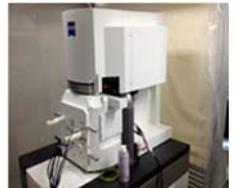
自動切削装置内蔵型の走査型電子顕微鏡。数千枚の連続撮影が可能
