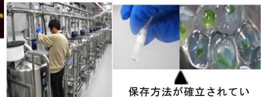
IBBPセンター内の生物遺伝資源保管用液体窒素タンク
