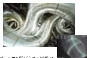
プラズマを閉じ込める磁場のかごを作るLHD内部と閉じ込められたプラズマ (右下。高温のプラズマは目に見える光を出さないで透けて見えます。)
