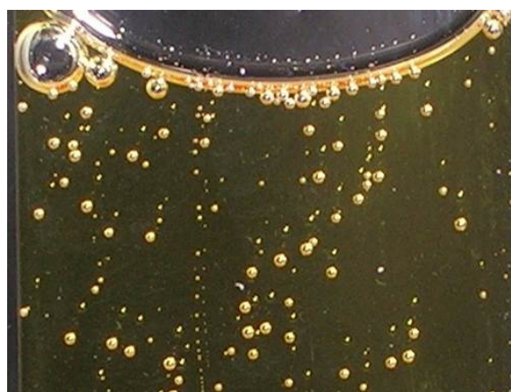
(図2) 水から酸素が発生している様子。水溶液中に金属錯体が溶けている。
