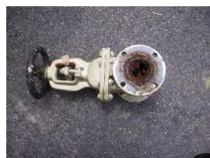
給水弁錆による詰り状況
