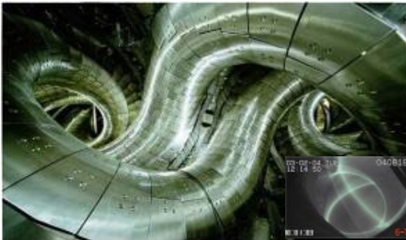
プラズマを閉じ込める磁場のかごを作るLHD内部と閉じ込められたプラズマ（右下。高温のプラズマは目に見える光を出さないで透けて見えます。）
