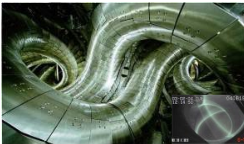
プラズマを閉じ込める磁場のかごを作るLHD内部と閉じ込められたプラズマ（右下。高温のプラズマは目に見える光を出さないの透けて見えます。）
