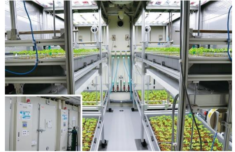
植物環境制御システム（ネットワークカメラにより遠隔地からの長期環境応答モニタリングが可能）
