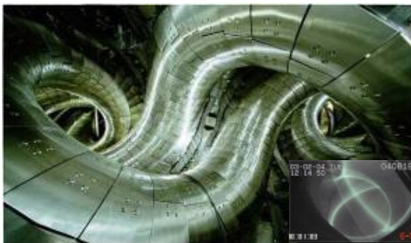
プラズマを閉じ込める磁場のかごを作るLHD内部と閉じ込められたプラズマ（右下。高温のプラズマは目に見える光を出さないのて透けて見えます。）
