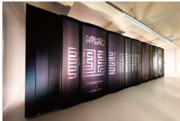
世界最速の天文学専用スーパーコンピュータ Cray XC30「アテルイ」。約1ペタフロップス(1秒間に1千兆回)の計算能力をもつ。
