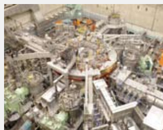
超高温プラズマを定常維持させる大型ヘリカル装置(LHD)
