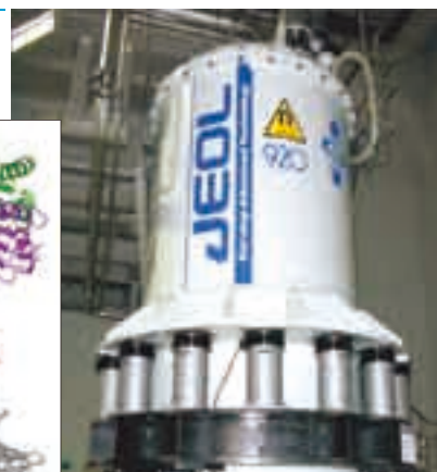
超高磁場NMR装置と、その利用によって解明されたタンパク質の構造
