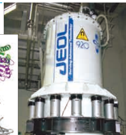
超高磁場NMR装置と、その利用によって解明されたタンパク質の構造
