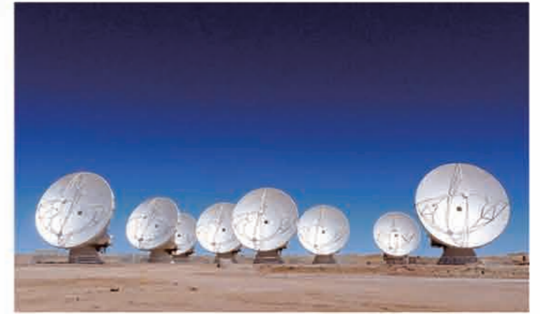
ALMA山頂施設に設置された8台の12mアンテナ
