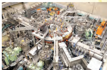
超高温プラズマを定常維持させる大型ヘリカル装置 (LHD)
