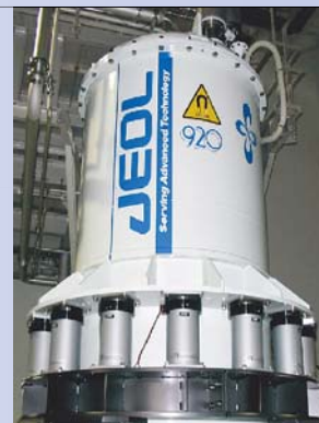
超高磁場NMR装置と、その利用によって解明された糖タンパク質の構造
