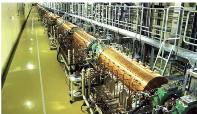
【J-PARCの加速器】 J-PARCでは、水素ガスを用いてイオン源から陽子を発生させ、リング加速器 (線形加速器) でエネルギーを400MeVまで加速します。J-PARCには、リングの他にRCSとMRという円形加速器があり、3台の大型加速器を用いて、陽子を光速の99.998%まで加速し、世界最大級の陽子ビーム出力を誇ります。
