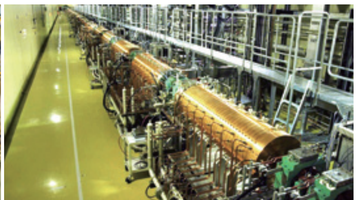
【J-PARCの加速器】J-PARCでは、水素ガスをういてイオン源から陽子を発生させ、リニアック（線形加速器）でエネルギーを400MeVまで加速します。J-PARCには、リニアックの他に「3GeVシンクロトロン」と「50GeVシンクロトロン」という円形加速器があり、3台の大型加速器を用いて、陽子を光速の99.98%まで加速します。
