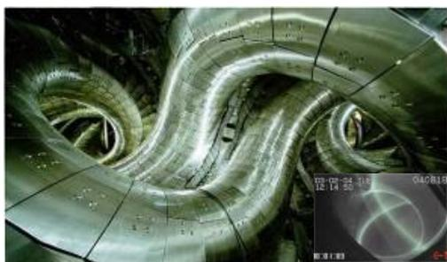
プラズマを閉じ込める磁場のかごを作るLHD内部と閉じ込められたプラズマ(右下。高温のプラズマは目に見える光を出さないの透けて見えます。)
