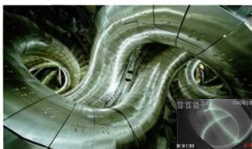
プラズマを閉じ込める磁場のかごを作るLHD内部と閉じ込められたプラズマ(右下。高温のプラズマは目に見える光を出さないで透けて見えます。)
