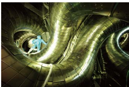
プラズマを閉じ込める真空容器内部
