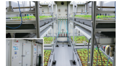
植物環境制御システム(ネットワークカメラにより遠隔地からの長期環境応答モニタリングが可能)
