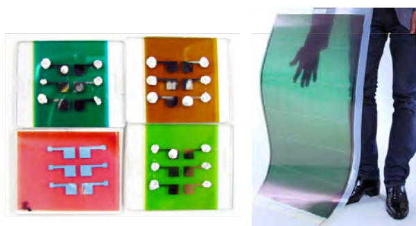
(図1) 有機太陽電池の写真。研究レベルの電池(左)と企業で試作された実用レベルの有機太陽電池モジュール(右)。フレキシブルで多色の太陽電池を自在に作製でき
