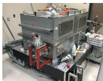
生命を宿せる系外惑星を探査する赤外線分光器IRD
