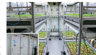
植物環境制御システム(ネットワークカメラにより遠隔地からの長期環境応答モニタリングが可能)
