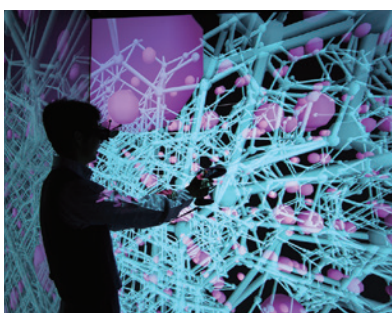
プラズマからの熱・粒子を受け止めるダイバーター材料の内部で、水素が拡散する様子のシミュレーションを可視化しています。
