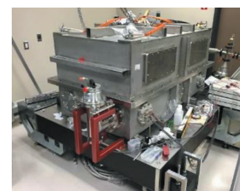
生命を宿せる系外惑星を探索する赤外線分光器IRD
